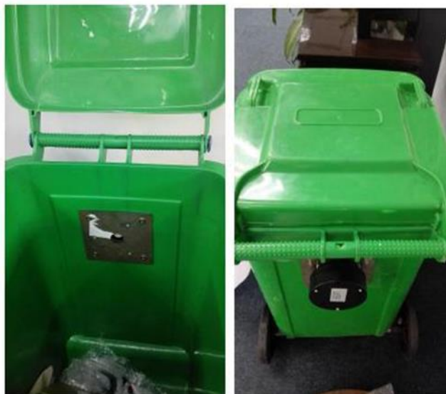
Рисунок 6 – Пример монтажа датчика ICB703 на стенку мусорного бака
