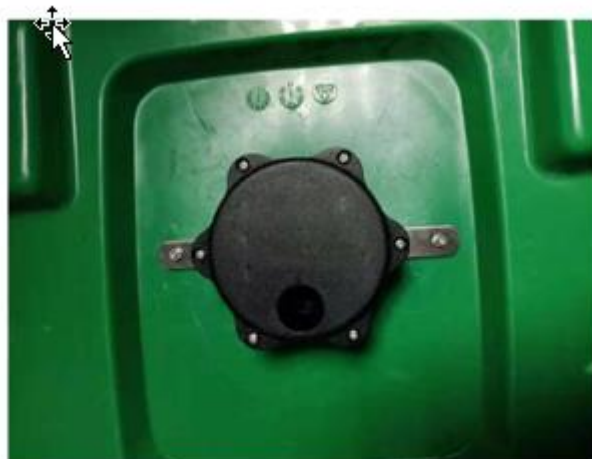
Рисунок 5 – Пример монтажа датчика ICB703 на крышку мусорного бака
